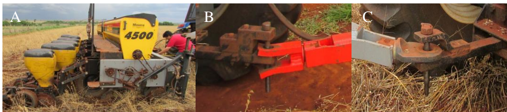
Figura 1. (A) Levantamento das características dos sistemas de engates das semeadoras adubadoras da Fazenda Experimental da UFGD. (B) e (C) sistemas de engates das semeadoras adubadoras da Fazenda Experimental da UFGD.
