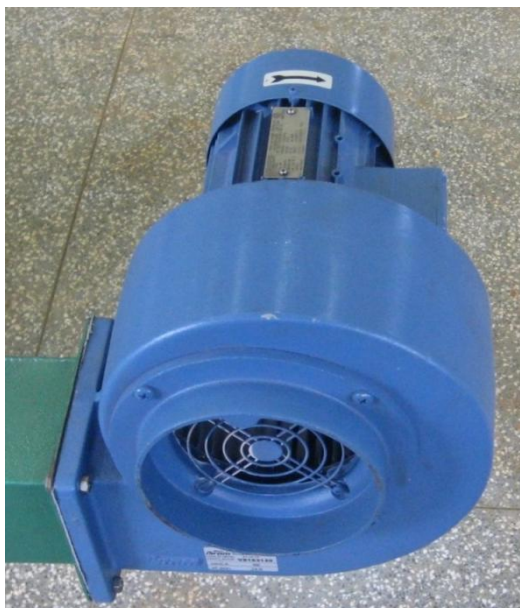
Figura 12. Ventilador Siroco, fabricante Ibram, modelo VSI-160.
