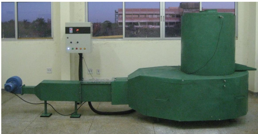
Figura 14. Secador experimental para secagem em camada delgada e espessa de produtos agrícolas.
