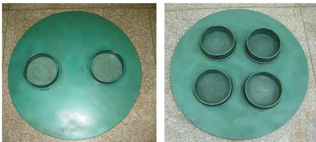
Figura 5. Câmara de secagem em camada delgada com 2 bandejas (à esquerda) e com quatro bandejas (à direita).
