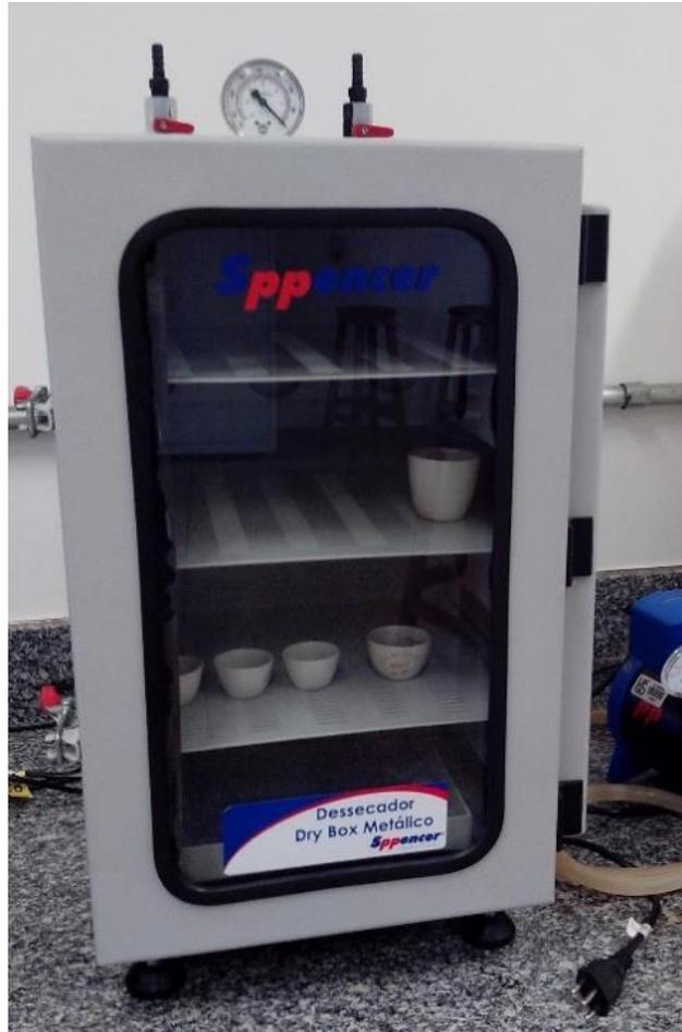
**Figura 3 - Dessecador Dry Box Metálico Sp Spencer SP4960-55**
