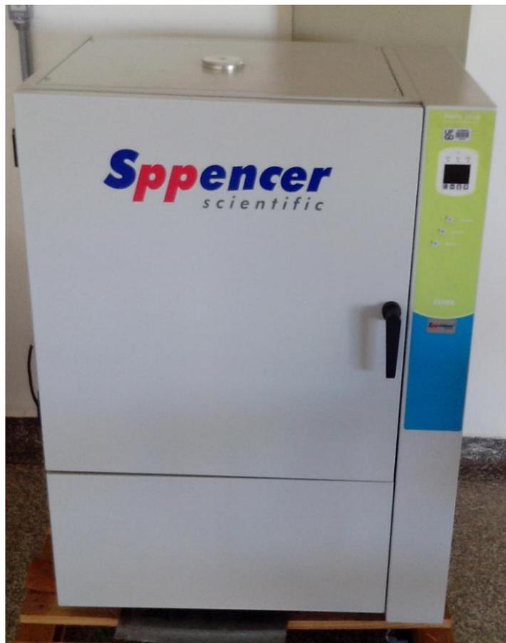
Figura 1 – Estufa utilizada nos ensaios (Sppencer/Nova Ética 420 – 1D)
