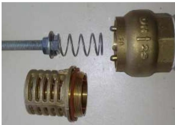
**Figura 3** - Forma de ajuste realizado na válvula de retenção. (Fonte própria).
