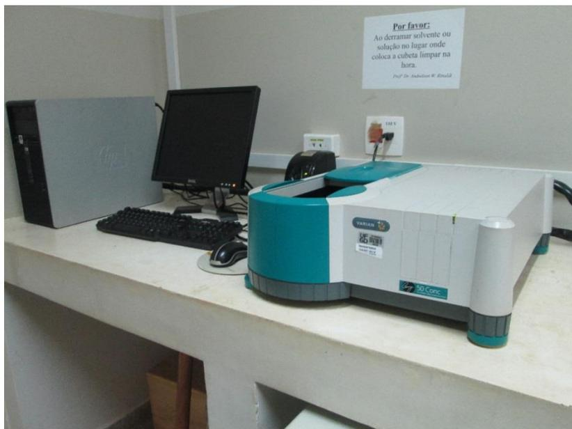
Figura 3 - Espectrofotômetro de Absorção UV-Vis Cary 50–Varian
